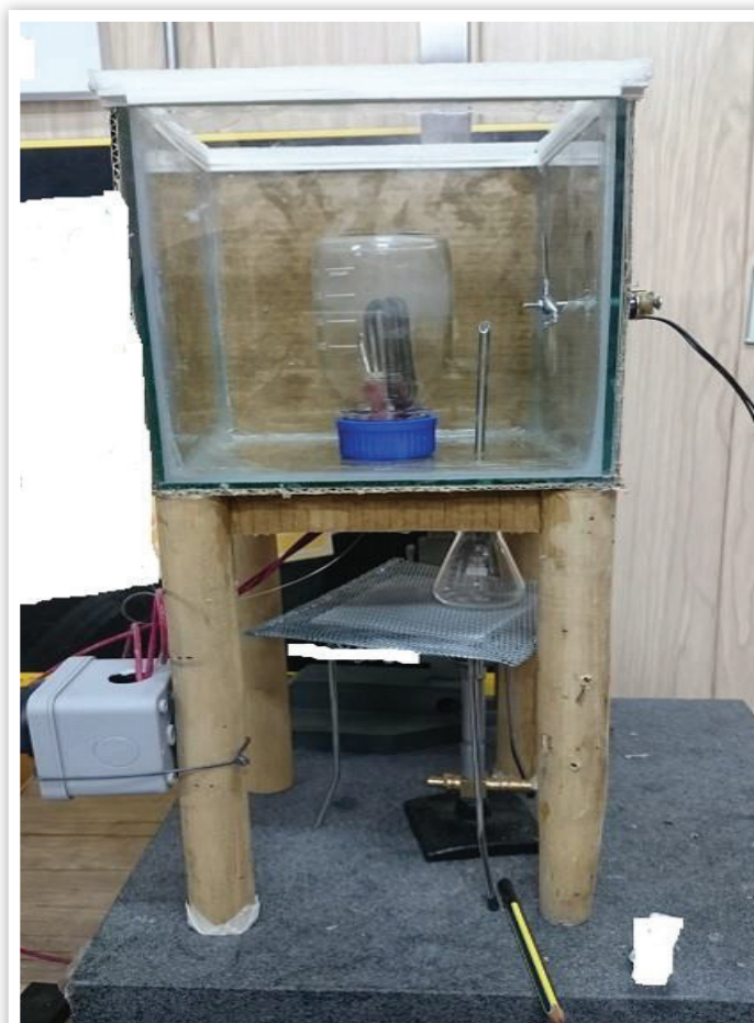
دستگاه بایندر زدایی کاتالیستی ساخته شده.
