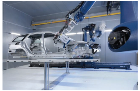
تست‌های غیرمخرب بر روی بدنه خودرو در حین ساخت
